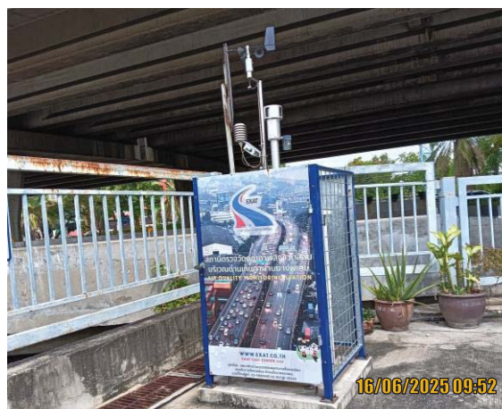
รูปที่ 3.2-21 ระบบเฝ้าระวังคุณภาพสิ่งแวดล้อม แบบ Online Real-Time (บริเวณด่านเก็บค่าผ่านทางพิเศษรามอินทรา)
